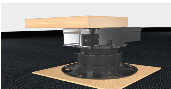
Befestigung einer Holzdiele auf dem Alu-Systemprofil EVO mithilfe des Rastverbinders (R).
