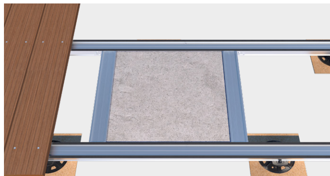
Zusätzliche Last durch z.B. schwere Steinplatten
